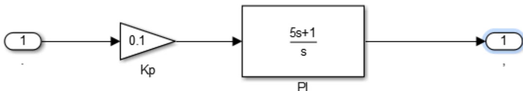
Figura 27 - controlador PI do inversor implementado no Simulink
