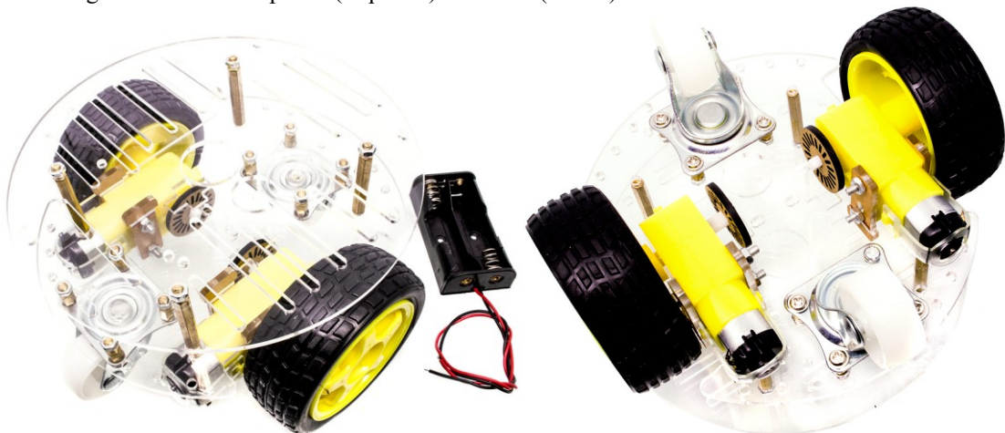
Figura 4.3 – Vista superior (esquerda) e inferior (direita) da estrutura de acrílico montada.
