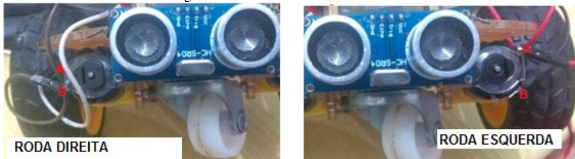
Figura 4.11 - Solda das conexões no motor.
