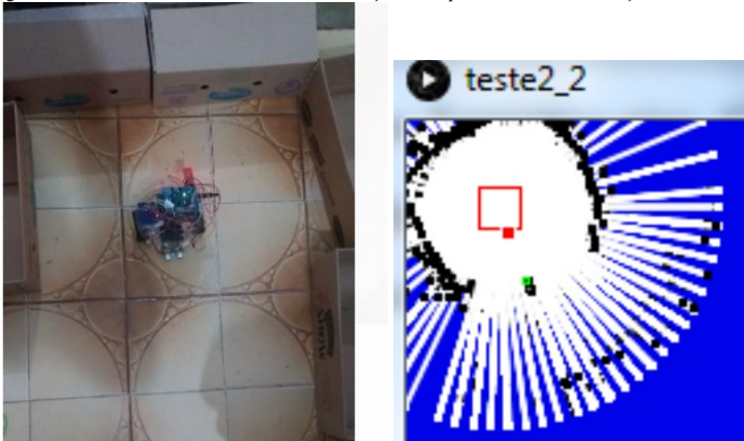
Figura 5.13 - Teste em ambiente real com a verificação do mapeamento e de sua exibição na interface.
