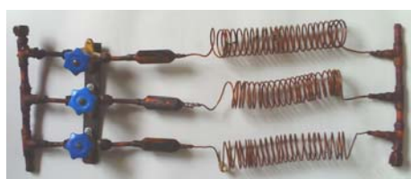
Figura 2.7 - Arranjo de tubos capilares utilizados no processo de expansão.
