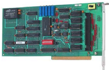
Figura 2.15 - Placa de aquisição de dados CIO DAS48 PGA.
