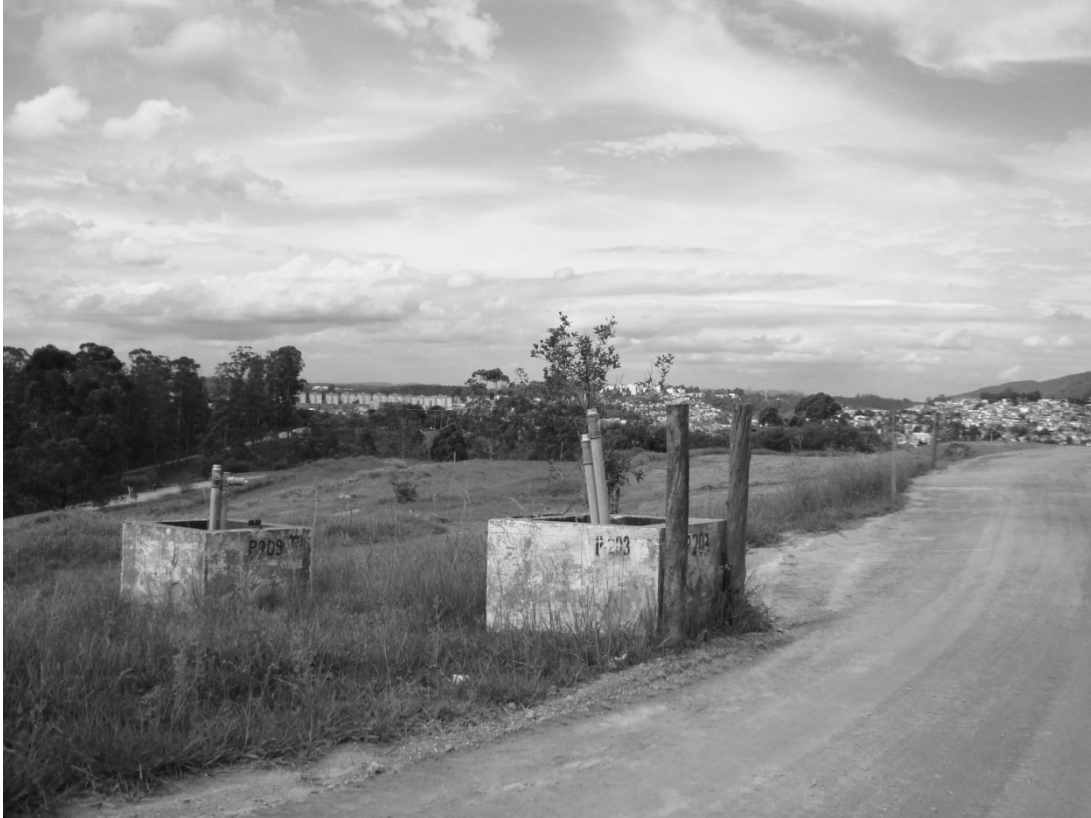
Figura 32: Piezômetros utilizados para medição de pressões dos fluidos, no aterro Bandeirantes, São Paulo - SP. Fonte: A autora, 2009.
