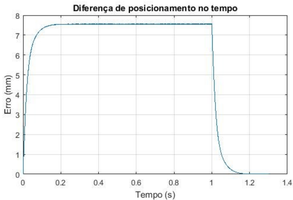
Figura 4.7 – Erro de posicionamento no tempo para perfil degrau de 300mm/s (Fonte: Elaborado pelo autor no software Matlab®.)
