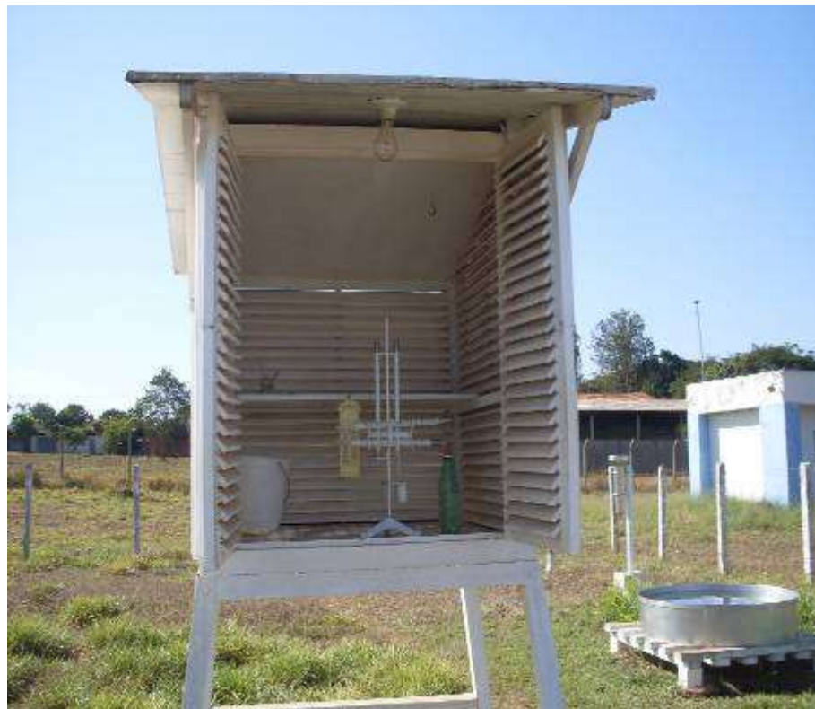
Figura 16 - Estação convencional, instalada em Morrinhos Goiás pelo INMET. Foto: Marilene R.S. Pimentel
