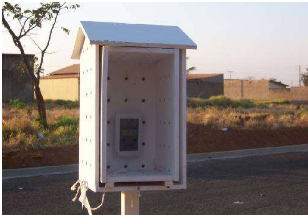
Figura 15 – Mini-abrigo meteorológico com termohigrômetro digital portátil instalado. Foto: Marilene R. S. Pimentel – 09/2008
