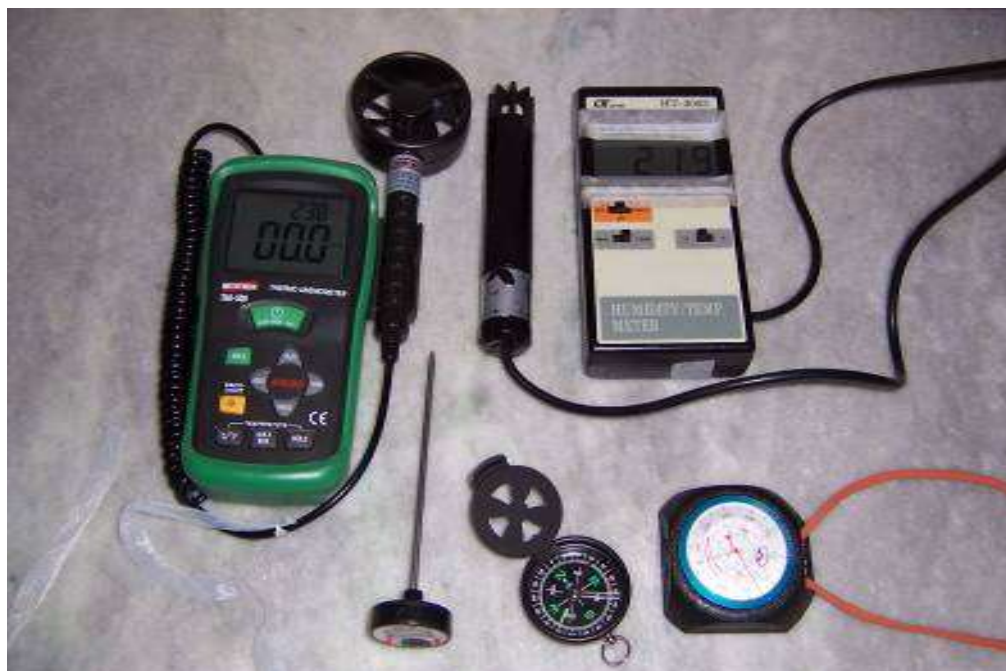
Figura 12 - Anemômetro digital para medir a velocidade do vento (à esquerda). termohigrômetro digital (à direita). Em detalhe as ventoinhas. Abaixo, termômetros bimetálicos com hastes, bússola e altímetro. Foto: Marilene R. S. Pimentel- 10/2008
