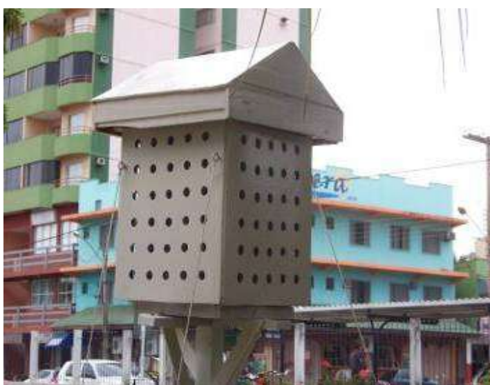
Figura 14 - Mini-abrigo utilizado para a instalação do data logger Foto: Marilene R. S Pimentel - 09/2008
