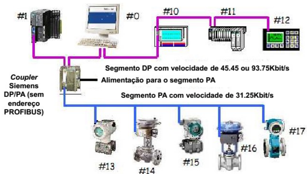
Figura 9- Rede Profibus DP e PA
