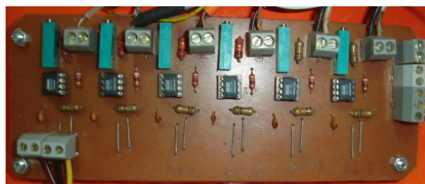
Figura 3.15 – Placa para o condicionamento dos sinais de pressão, vazão mássica de refrigerante e vazão mássica de água do evaporador.
