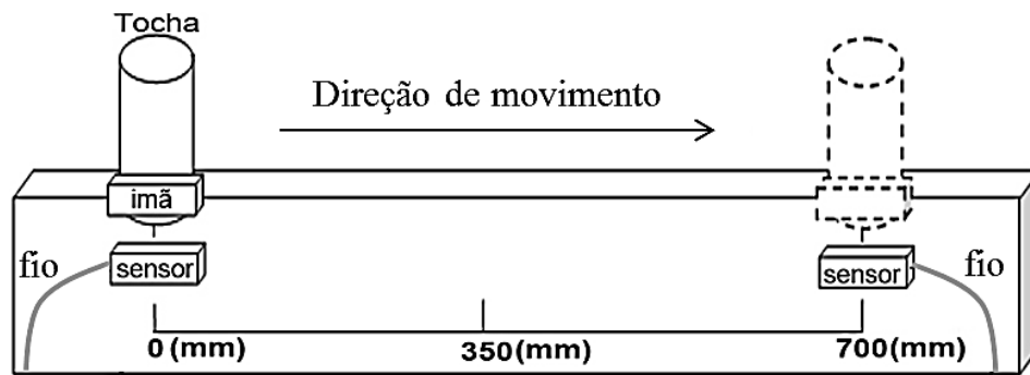
Figura 3.8 – Ilustração de calibração de velocidade na mesa de coordenadas
