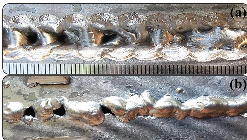
Figura 5.7– Aspecto superficial do cordão de solda sem nariz, tecimento realizado com 1,0 s de tempo de parada lateral e 1,0 s de tempo de transição, abertura do chanfro 2,5 mm: (a) – vista superior, face; (b) – vista inferior, raiz
