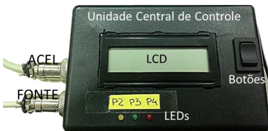
Figura 3.10 – CONPARTE: sistema real e seus componentes
