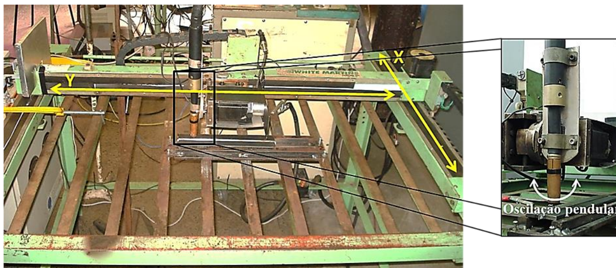
Figura 3.7 – Mesa de coordenadas X-Y com oscilação pendular, utilizada para a realização dos experimentos
