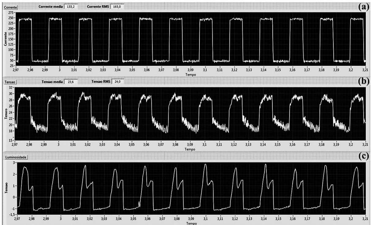
Figura 4.4 – Oscilogramas para I_m = 130 A e t_p = 9 ms, onde: (a) – corrente; (b) – tensão; (c) – sinal de luminosidade mostrando testemunhando uma única gota por pulso no fim de pulso
