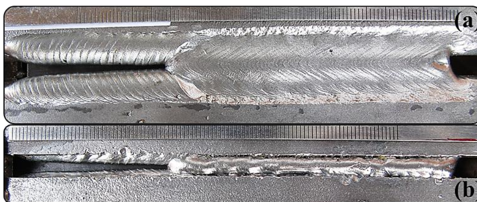
Figura 5.13 – Aspecto superficial do cordão de solda com nariz; tecimento realizado com 0,20 s de tempo parada lateral e 0,20 s de tempo de transição, amplitude de 14 mm abertura do chanfro 6 mm: (a) – vista superior, face; (b) – vista inferior, raiz
