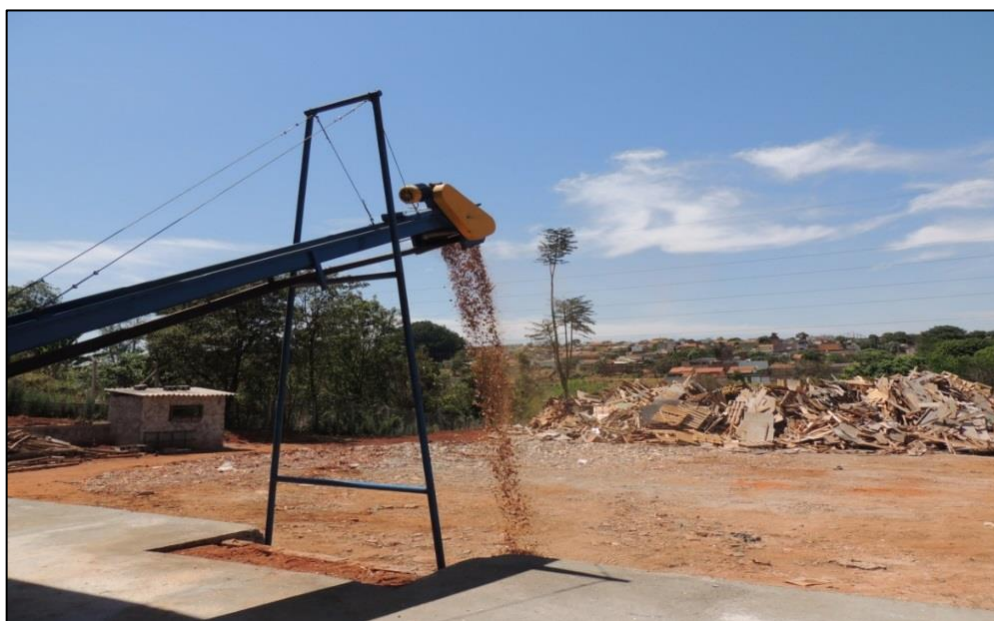
Figura 49 – Uberlândia, picador de madeira em cavacos de uma empresa transportadora de RCD, 2.013
