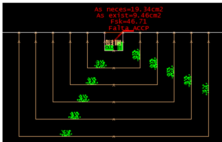
Figura 37 – Falta de armadura de combate ao colapso progressivo pilar P2
