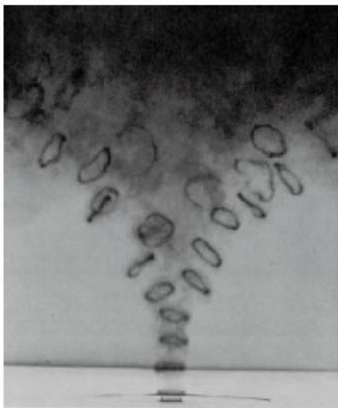
Figura 2.6 - “Blooming jets”: Resultados experimentais de Lee e Reynolds (1985), Koumoutsakos et al. (1998).
