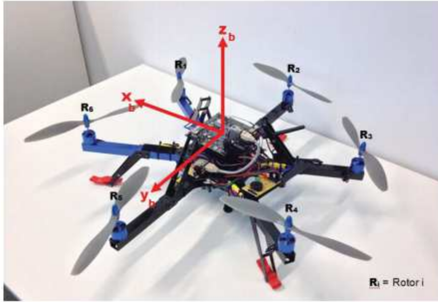
Figura 2.1 – Sistema de coordenada BCS fixo no centro de gravidade da aeronave. Fonte: Fogelberg (2013)
