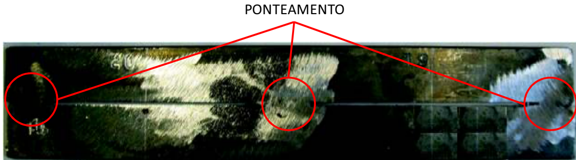
Figura 3.12 – Posição do ponteamto realizado na placa de teste com junta em I e folga de 1,5 mm (notar a presença dos espaçadores e o esmerilhamento para retirada do excesso dos pontos)
