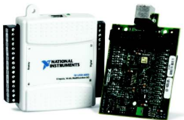
Figura 3.16 – Placa de aquisição modelo NI USB-6009 com resolução de 14 bits e faixa de medição de \pm 10 V (NATIONAL INSTRUMENTS, 2009a)
