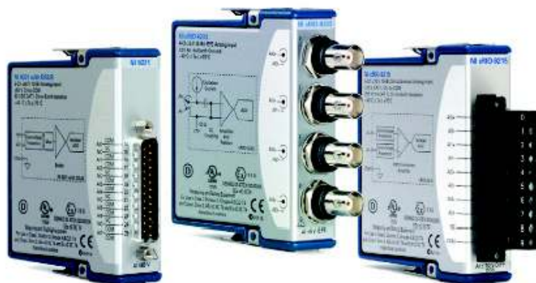
Figura 3.17 – Placa de aquisição modelo NI 9211 com resolução de 24 bits e faixa de medição de \pm 80 mV (NATIONAL INSTRUMENTS, 2009b)
