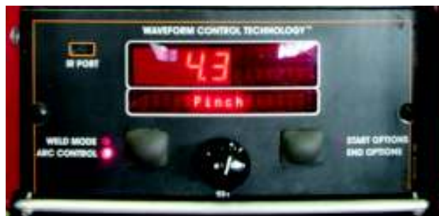
Figura 6.1 – Pannel auxiliar do alimentador de arame (controlador de forma de onda) do equipamento Power Wave 455/STT da Lincoln Electric, mostrando a opção de regulagem do efeito pinch
