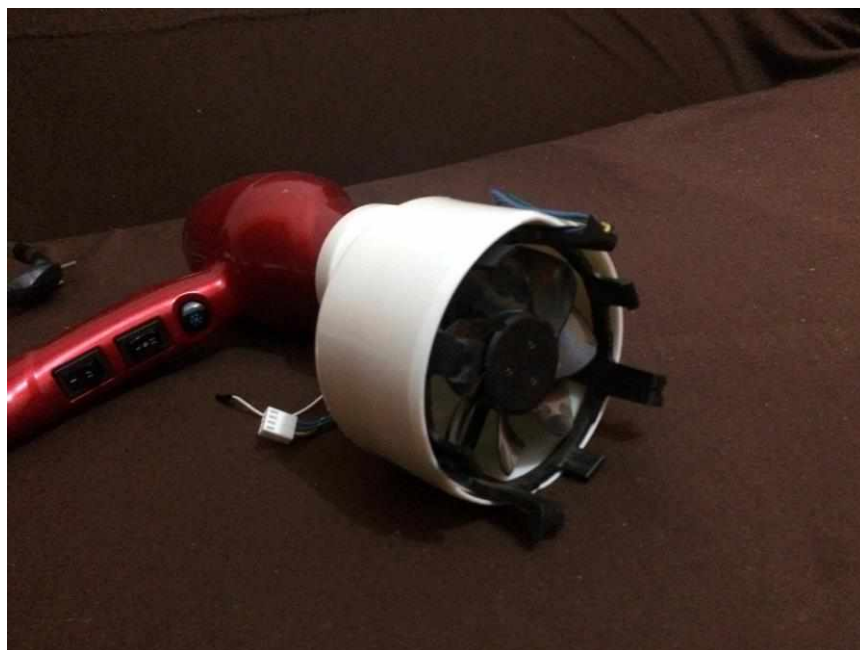
Figura 37. Secador de cabelos usado como fonte de ar e cooler de computador usado como sensor de vazão
