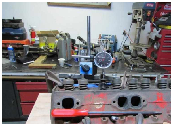
Figura 2. O relógio comparador é utilizado para determinar a posição das válvulas e então o cabeçote é submetido à uma bancada de fluxo (CORRAO, 2014)
