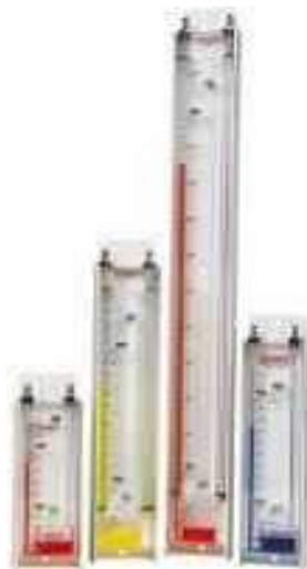
Figura 10. Tubo em U para medição de pressão
