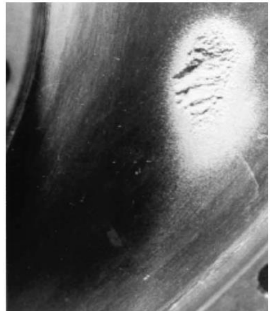
Figura 14: a) Formação de uma "nuvem" de bolhas em uma determinada região e b) Erosão causada pelo impacto desta nuvem de bolhas (Brennen, 1995)
