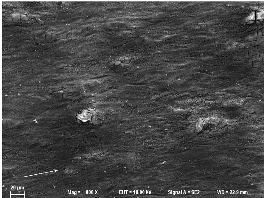
Figura 60: MEV na região de ângulo de aproximadamente 70° com ampliação de 800x
