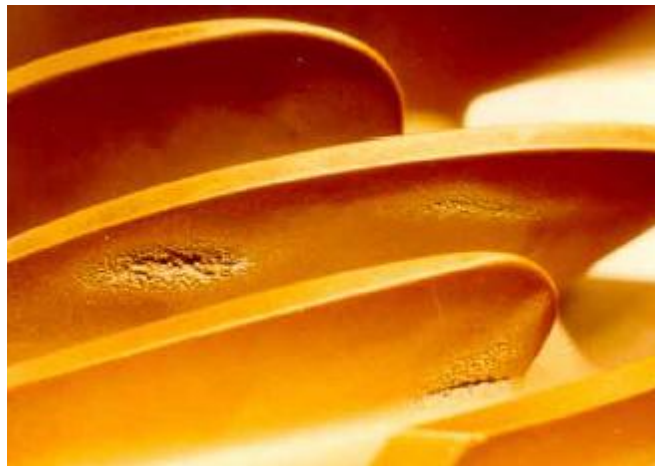
Figura 15: Mais um exemplo de erosão por cavitação nas pás de um rotor (Brennen, 1995)
