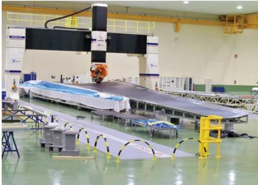
Figura 26 – Processo de colocação automatizada de fitas na fabricação da asa da aeronave Airbus A350.
