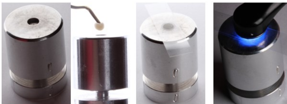
Figura 3- Sequência de confecção das amostras
