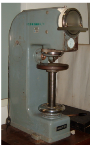
Figura 3.15 - Durômetro Universal Wolpert utilizado nos ensaios de dureza
