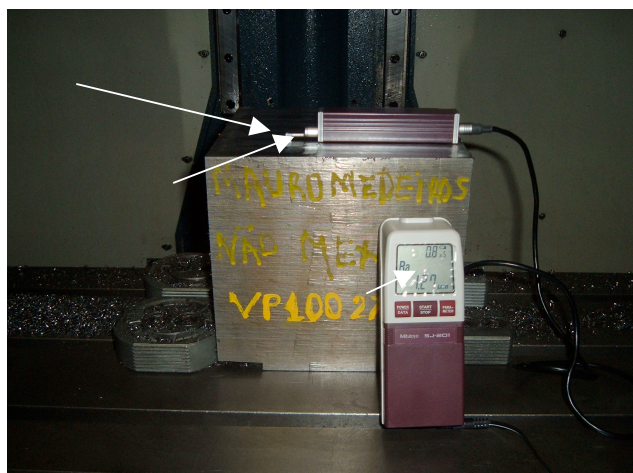
Figura 3.9 - Esquema de montagem do rugosímetro
