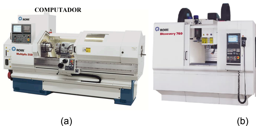
Figura 3.6 - Máquinas-ferramenta utilizadas nos ensaios: a) Torno Mecânico Multiplic 35D b) Centro de Usinagem Discovery 760
