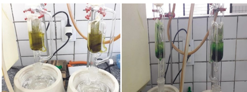
Figura 21 - Extração do óleo essencial das cascas e folhas do limão pelo método Soxhlet.
