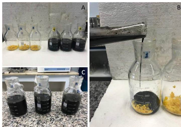
Figura 23 - Preparo da mistura substrato-lodo para digestão anaeróbia.
