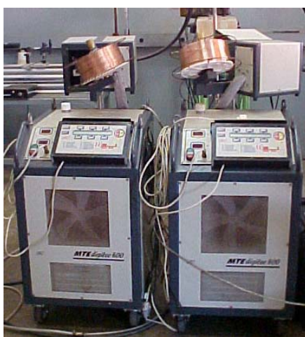
Figura 3.2 – Fontes de Soldagem MTE DIGITEC 600 e Cabeçotes STA-20 trabalhando interligadas como MIG/MAG duplo arame (potencial único ou isolado)
