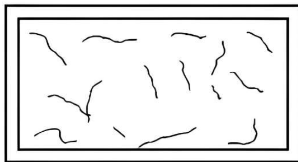
Figura 29: Modelo de fissuração típico de lajes por recalque (RIPPER; SOUZA, 2009)
