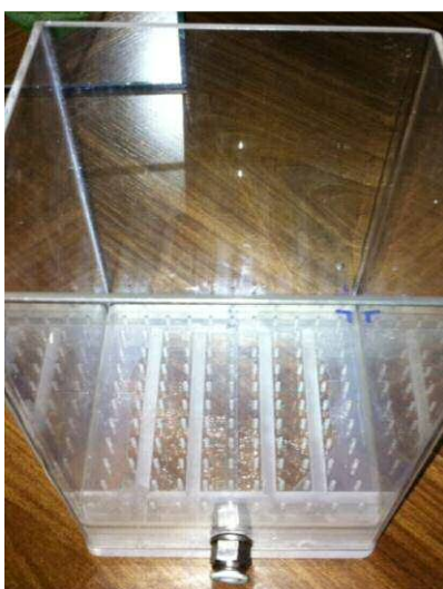
Figura 8: Ilustrações dos jarros adaptados após colocação da placa de distribuição de água saturada com ar (a) e depois de concluída sua instalação (b).
