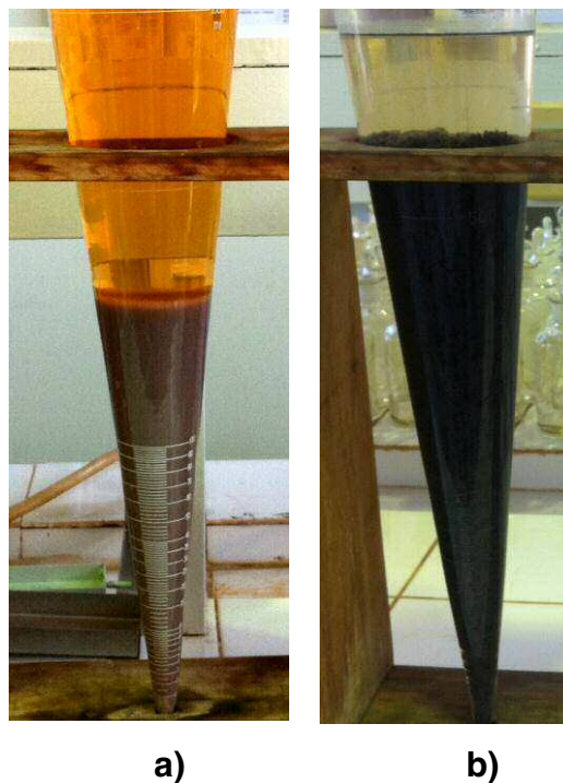
Figura 34: Ilustrações dos ensaios de coagulação e floculação em condições otimizadas, com emprego de coagulantes diferentes, sendo: a) Sulfato de Alumínio e b) Tanfloc SL.
