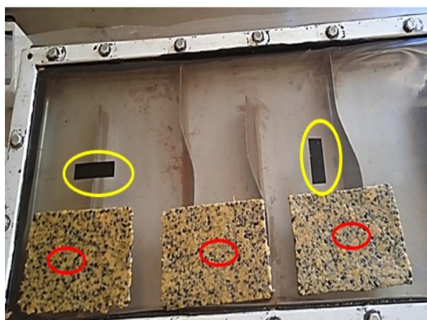
Figura 16 – Aferições de temperaturas das amostras e da unidade experimental; Os círculos amarelos representam os locais de aferição da temperatura da superfície do secador enquanto os círculos vermelhos exemplificam da região de leitura da temperatura da amostra.
