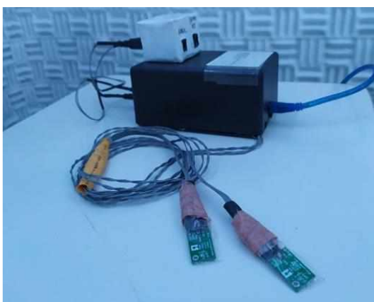
Figura 4 - TREMSEN e os sensores inerciais utilizados neste estudo.
