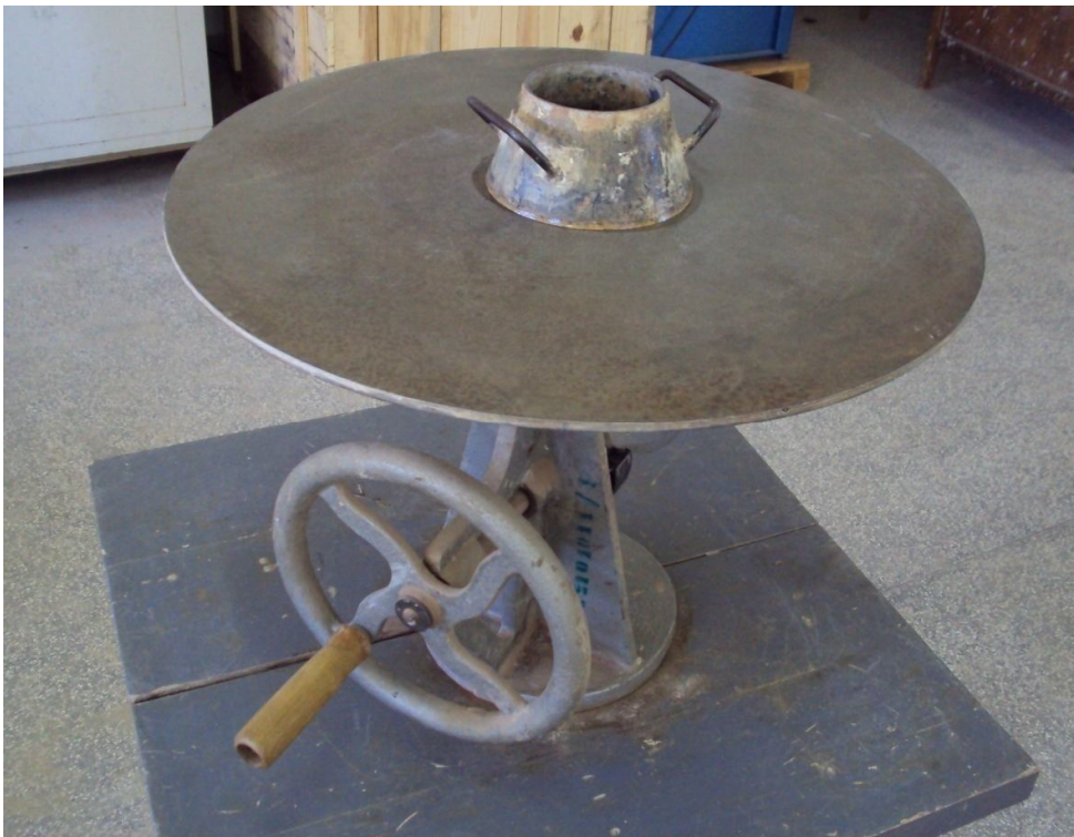
Figura 25. Mesa de abatimento utilizada na determinação do índice de consistência.
