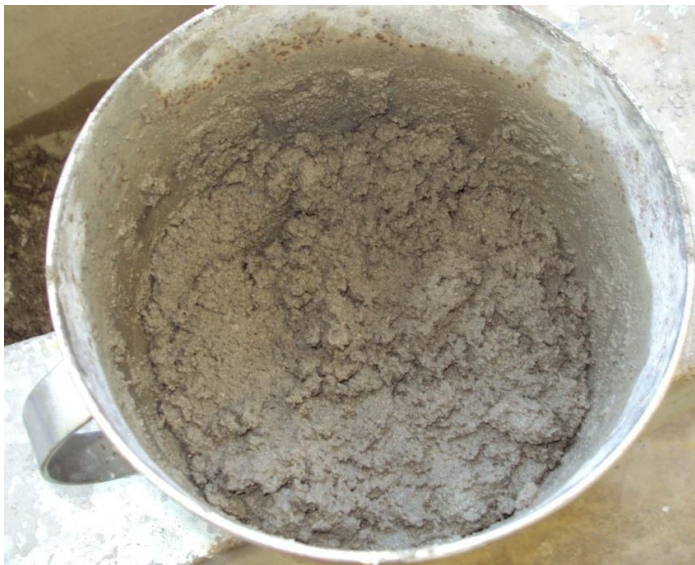
Figura 24. Argamassa preparada segundo a norma NBR7215. 75
