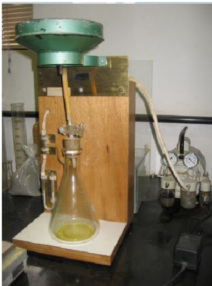
Aparelhagem para determinação de retenção de água em argamassas.
