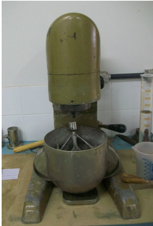
Figura 23. Misturador mecânico usado no preparo das argamassas
