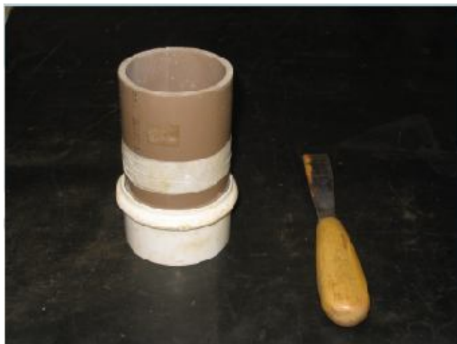
Figura 26. Copo de PVC utilizado para determinação da densidade da argamassa.
