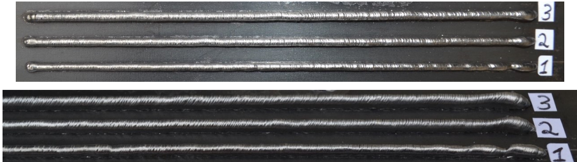
Figura 5.1 - Avaliação da velocidade de alimentação do arame com 2,0 m/min (1), 2,5 m/min (2) e 3,0 m/min (AUTOR, 2017).
