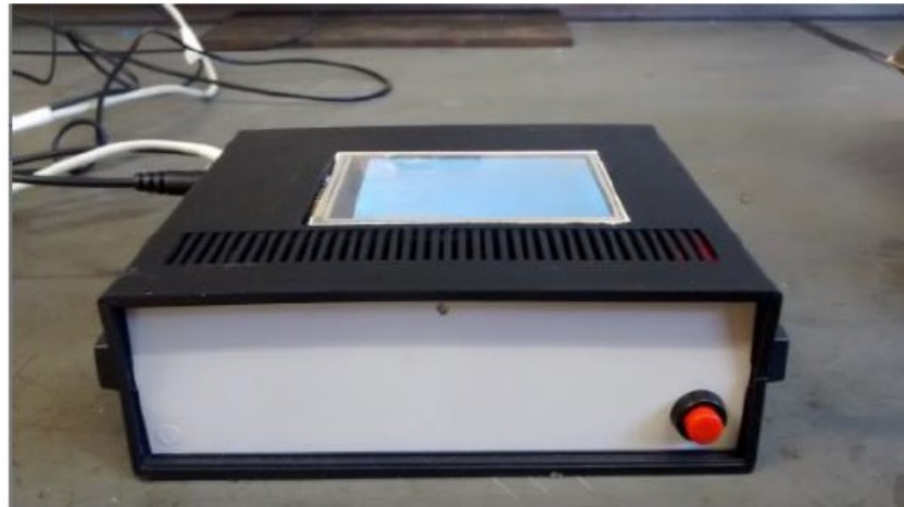
Figura 23 - Botão Reset do equipamento de controle
