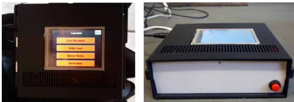
Figura 3.2 - Equipamento de Controle de Deslocamento da Tocha com Arquitetura ARM (JORGE, 2014).
