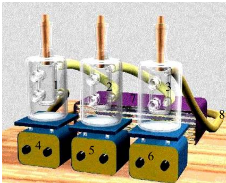
Figura 3.3 – Esquema do aparato experimental: 1, 2 e 3 – células de vidro encamisadas; 4, 5 e 6 – agitadores magnéticos; 7 – banho termostático; 8 – mangueiras de látex (OLIVEIRA, 2004).
