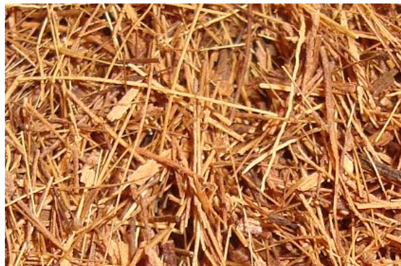
Figura 3.1.3 - Casca de coco verde obtido segundo o processo de preparação da matéria-prima proposta de moagem, secagem e peneiramento, granulometria 106 \mu\text{m} > D > 355 \mu\text{m} .
