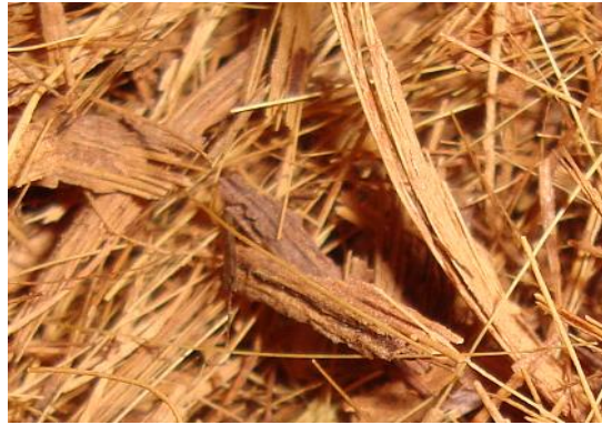
Figura 3.1.2 - Casca de coco verde obtido segundo o processo de preparação da matéria-prima proposta de moagem, secagem e peneiramento, granulometria > 355 \mu\text{m} .
