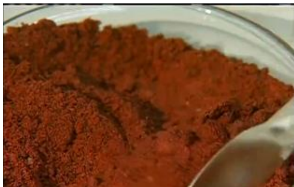
Figura 3.1.5 - Casca de jabuticaba obtido segundo o processo de preparação da matéria-prima proposta de moagem, secagem e peneiramento, granulometria < 106 \mu\text{m} .
