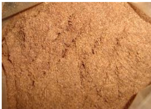
Figura 3.1.4 - Casca de coco verde obtido segundo o processo de preparação da matéria-prima proposta de moagem, secagem e peneiramento, granulometria < 106 \mu\text{m} .
