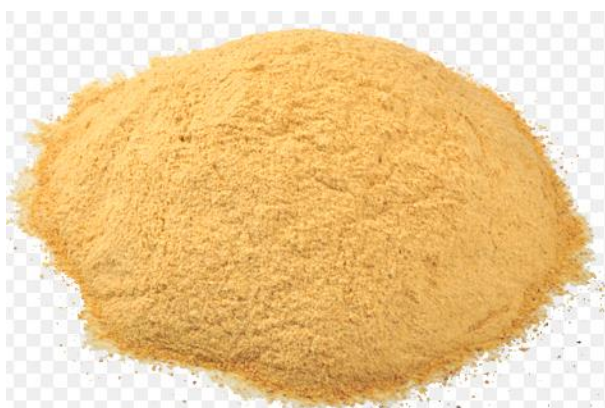
Figura 3.1.7 - Pó de casca de laranja obtido segundo o processo de preparação da matéria-prima proposta de moagem, secagem e peneiramento, granulometria < 106 \mu\text{m} .
