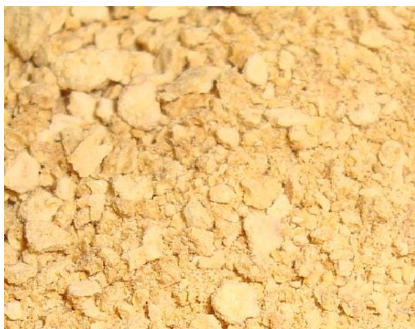
Figura 3.1.6 - Casca de laranja obtido segundo o processo de preparação da matéria-prima proposta de moagem, secagem e peneiramento, antes do processo de separação.
