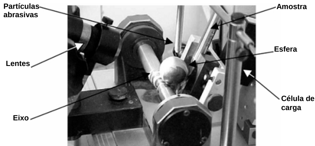
Figura 2.22 - Versão de um equipamento utilizado para ensaio de microabrasão (Santos et al., 2004).
