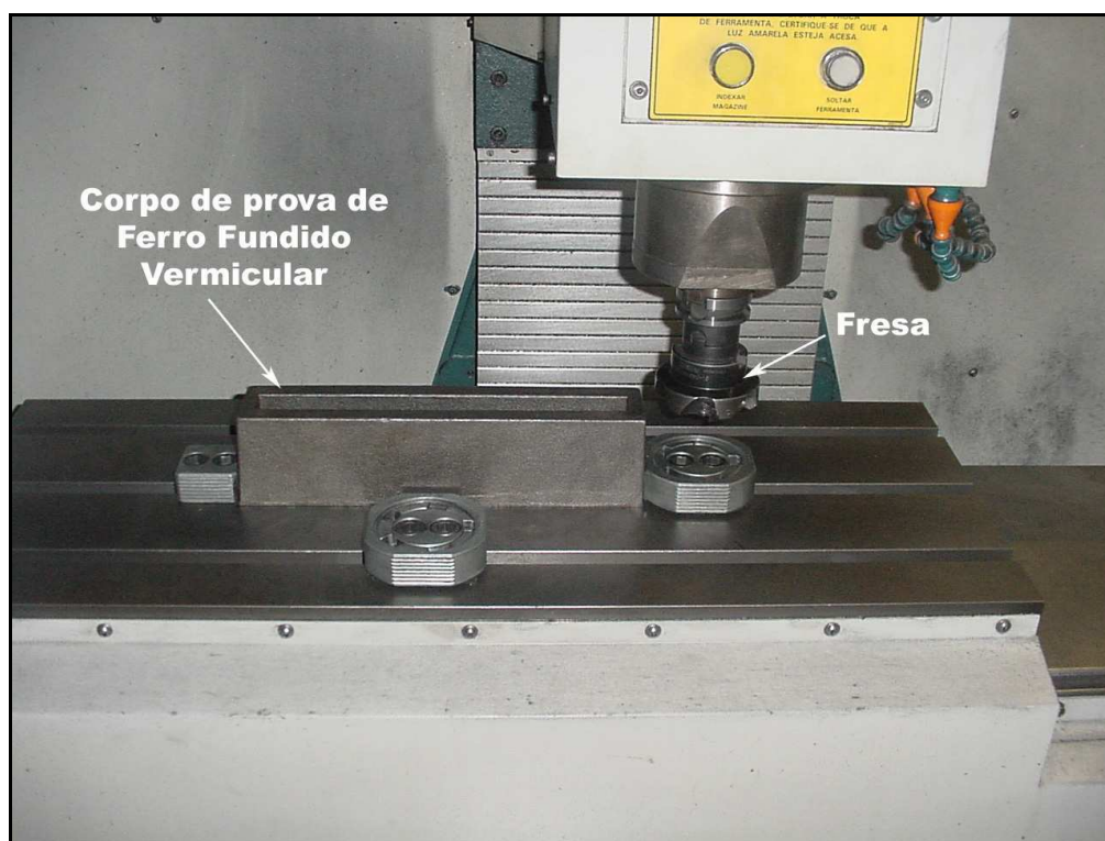
Figura 3.9 - Aparato de montagem dos pré-testes e ensaios de vida no fresamento frontal de ferro fundido vermicular.
