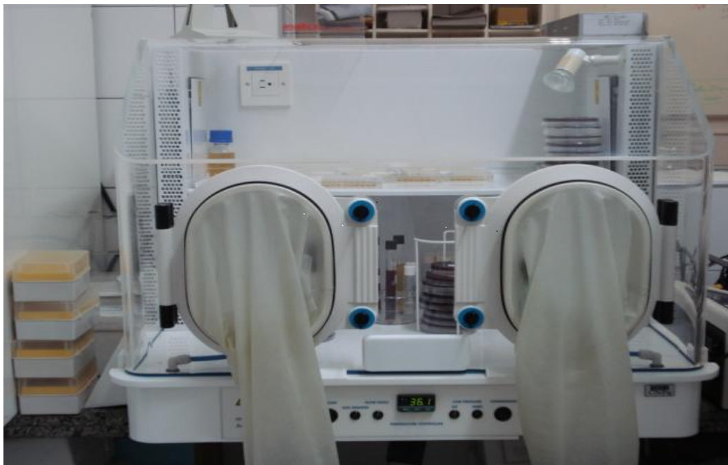
Figura 11 - Câmara de anaerobiose para incubação de microrganismos anaeróbios.
