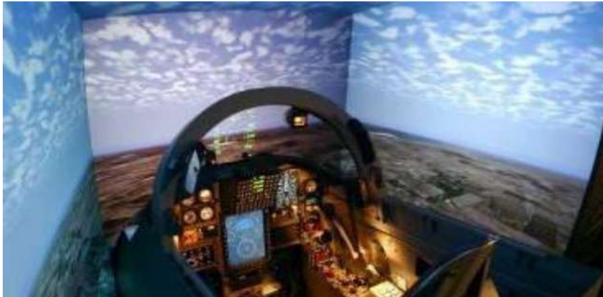
Figura 21 - Um sistema de CAVE com o uma cabine de voo, construído com todos os botões e formas necessárias.
