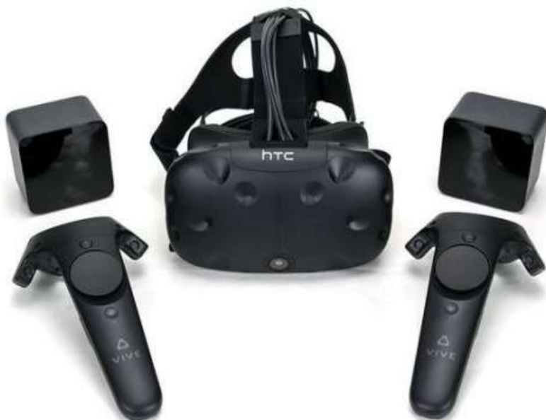
Figura 24 - Pacote HTC VIVE que inclui capacete, comandos e os lighthouses que são necessários na captura de movimento.
