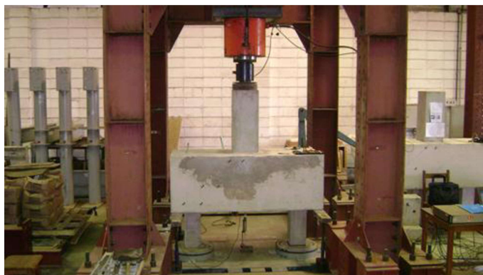
Figura 8 – Montagem de um ensaio de blocos sobre estacas.
