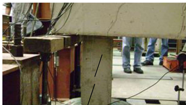
Figura 10 - Fissuras junto às estacas, blocos com conformação rugosa.
