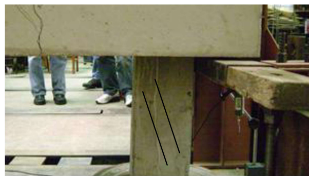
Figura 10 - Fissuras junto às estacas, blocos com conformação rugosa.
