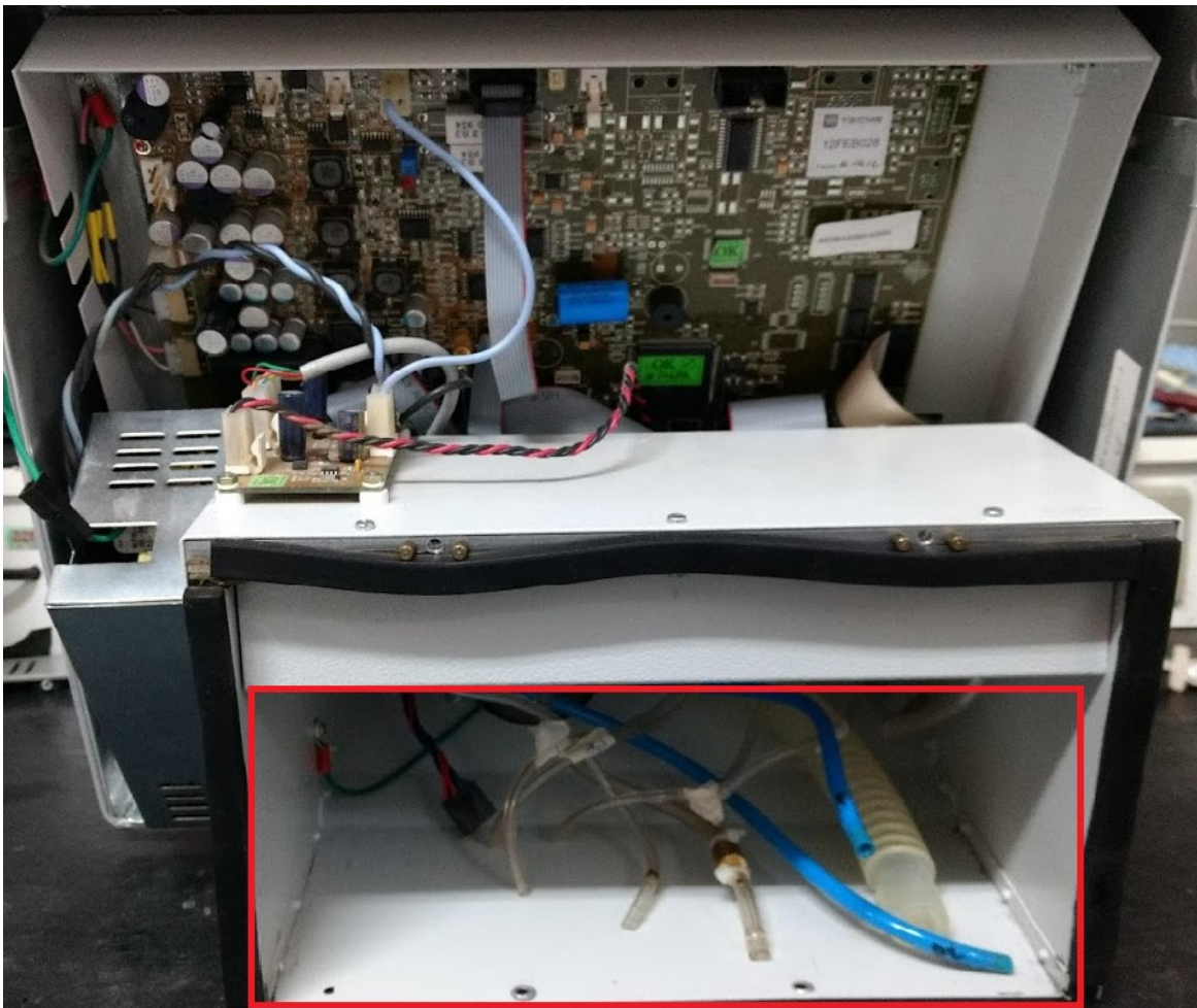
Figura 17: Compartimento de válvulas antes de conectar.
