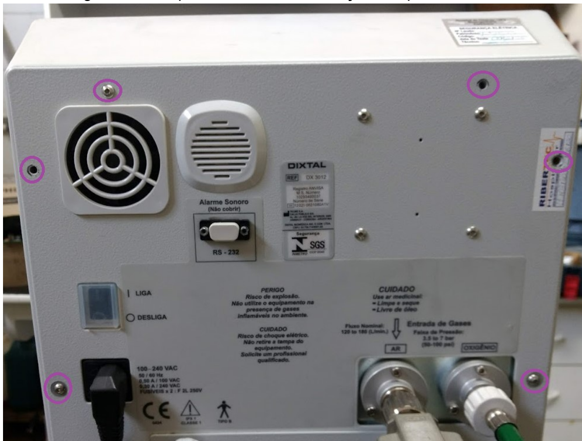
Figura 5: Vista posterior com as marcações do parafusos Allen
