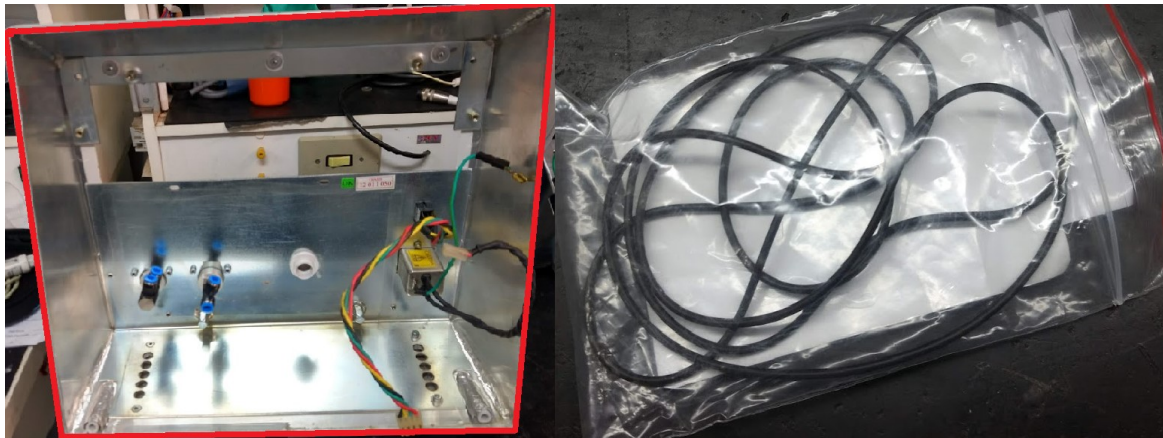
Figura 21: Local de posicionamento da junta de fechamento do Ventilador Pulmonar
