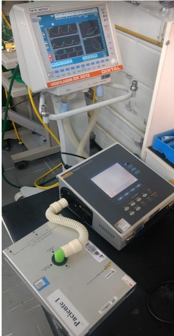
Figura 36: Conexão com o simulador de pulmão.
