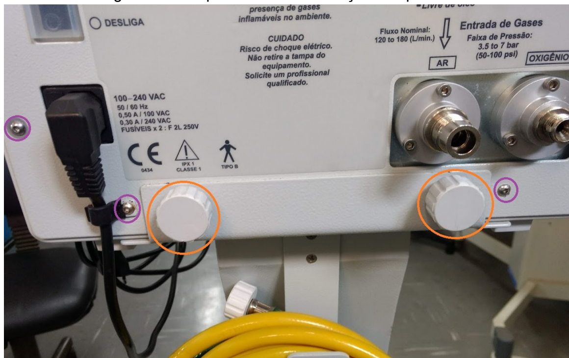
Figura 4: Vista posterior com indicação dos parafusos
