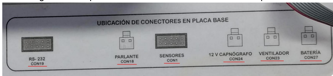
Figura 23: Sequência dos conectores eletrônicos da tampa traseira
