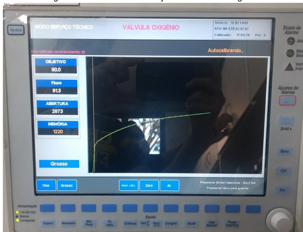
Figura 31: Tela de auto calibração da válvula de oxigênio.
