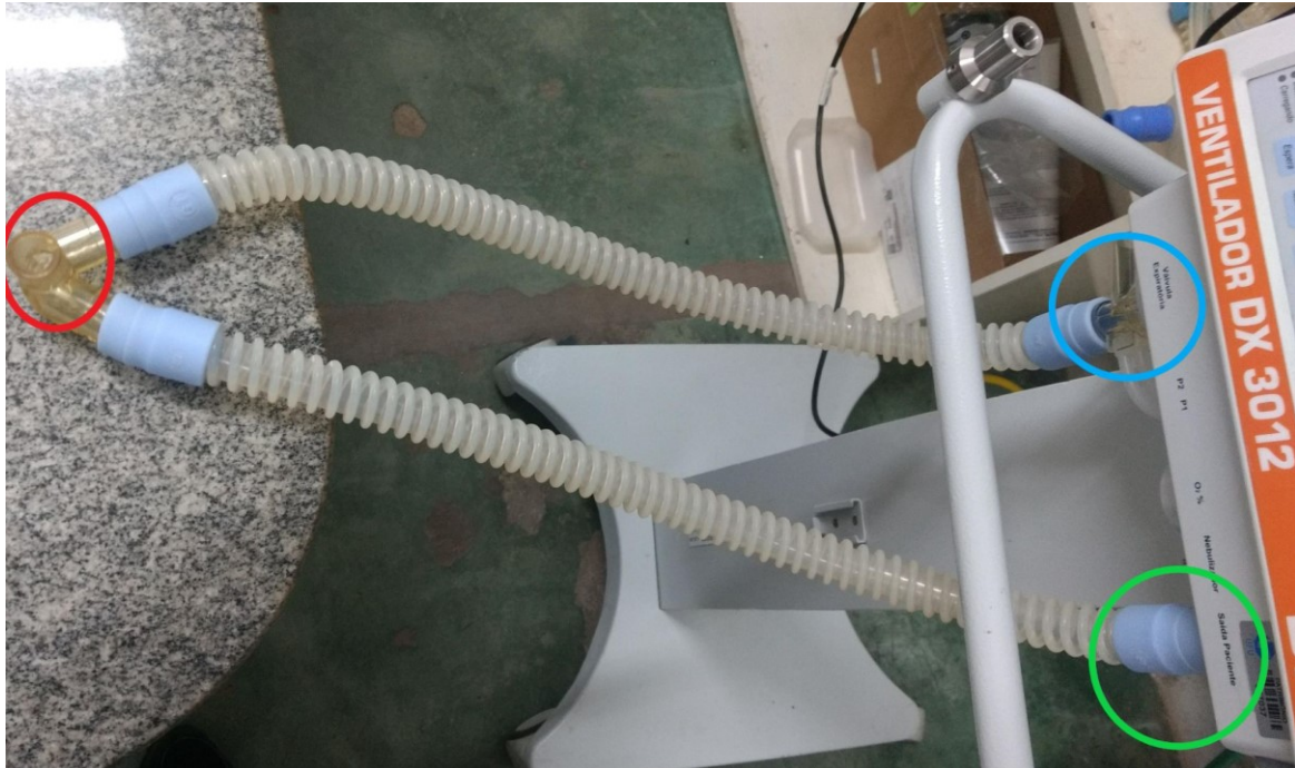
Figura 2: Conexão das traqueias de silicone.
