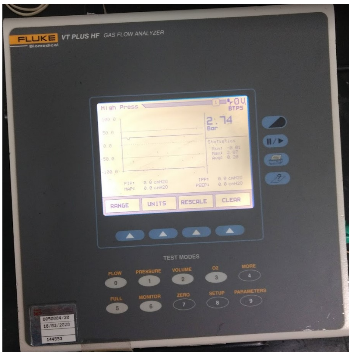
Figura 15: Analisador de gases apresentando o valor ideal de pressão da válvula de ar.
