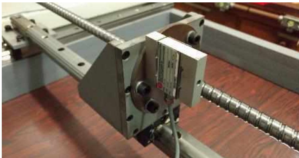
Figura 4.5 – Montagem para controle de admitância.
