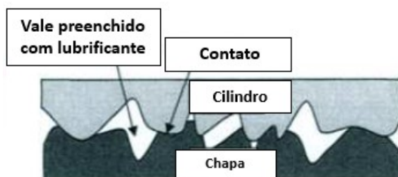
Figura 2.2 – Contato em um processo de laminação lubrificado. Adaptado de LENARD (2002).
