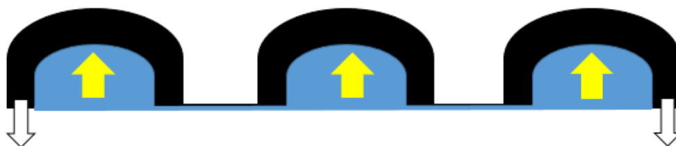
Figura 6.14 – Surgimento dos pilares na chapa (em azul) devido à extrusão reversa dos mesmos para dentro dos bolsos do cilindro (na cor preta).
