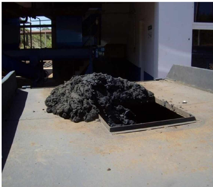
FIGURA 1. Retirada de lodo do reator da centrífuga. (Alves Filho, 2014)
