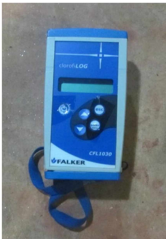
FIGURA 4. Aparelho Clorofilog utilizado na obtenção dos valores diretos de clorofila a e b.
