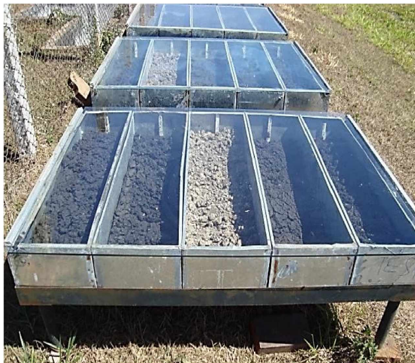
FIGURA 2. Lodo em processo de solarização. (Alves Filho, 2014)
