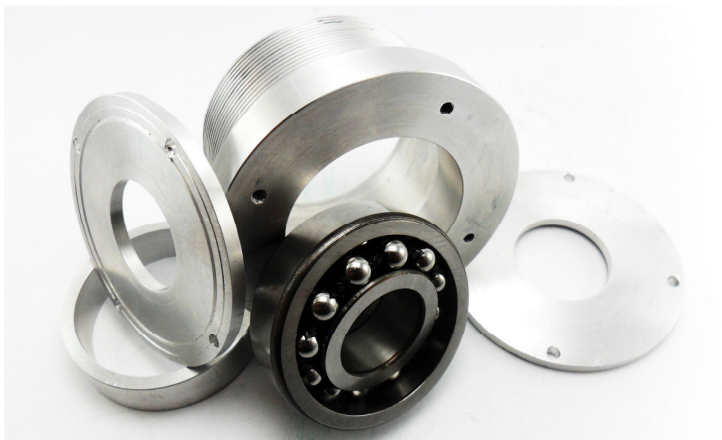
Figura 6.21 – Dispositivo construído para a adaptação do rolamento autocompensador no mancal híbrido.
