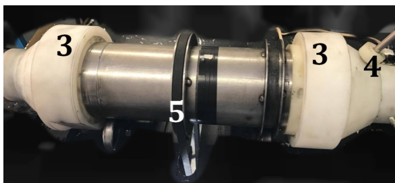
Figura 3.4 – (3) Peças fixas de tecnil com anéis de teflon (4) Entrada da alimentação (5) Correia envolta na parte central do cilindro.
