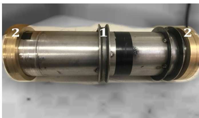
Figura 3.3 – (1) Cilindro aço inox 12 cm Diâmetro x 36 cm Comprimento (2) Bases de Bronze.
