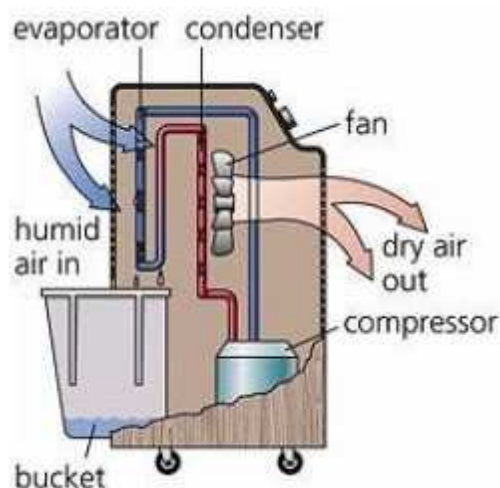
Figura 9: Como funciona um desumidificador. Fonte: http://www.theairgeeks.com/dehumidifier/
