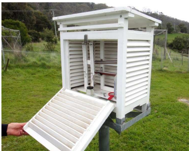
Figura 8: Stevenson Screen , ou anteparo de Stevenson (abrigo para sensores). Fonte: http://aaybee.com.au/images/StevensonScreen.jpg
