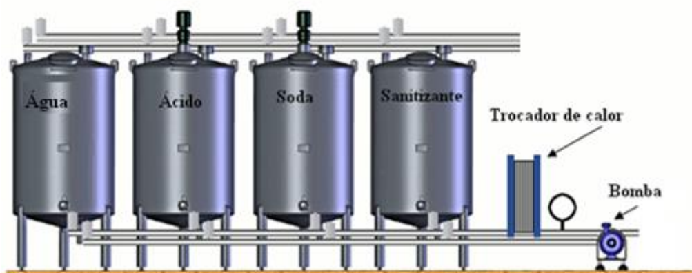
Figura 2.2. Componentes típicos de um sistema CIP Fonte: FORNI (2007)
