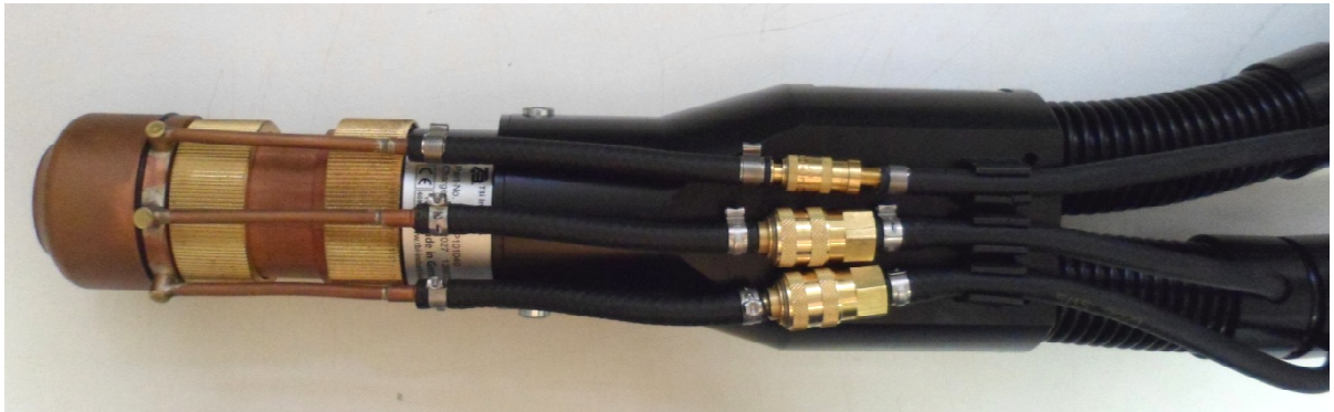
Figura 3.6 – Tocha para soldagem com o processo "Plasma-MIG" com Arcos Concêntricos modelo PLM 900
