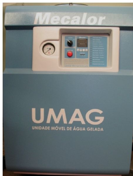
Figura 3.10 - Unidade Móvel de refrigeração de água, Fabricante Mecalor, Modelo: UMAG MAS-9-RI-220
