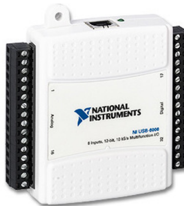
Figura 3.13 - Placa de aquisição tipo “Plug and Play” da National Instruments modelo: NI USB-6009
