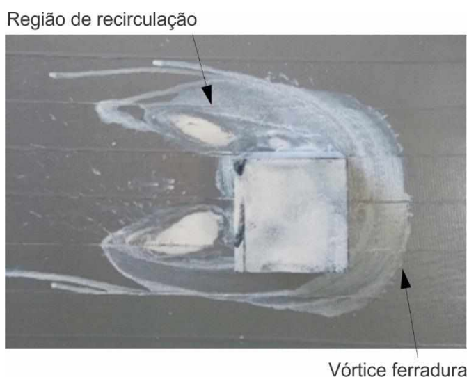
Figura 67 – Vórtice ferradura e região de recirculação
