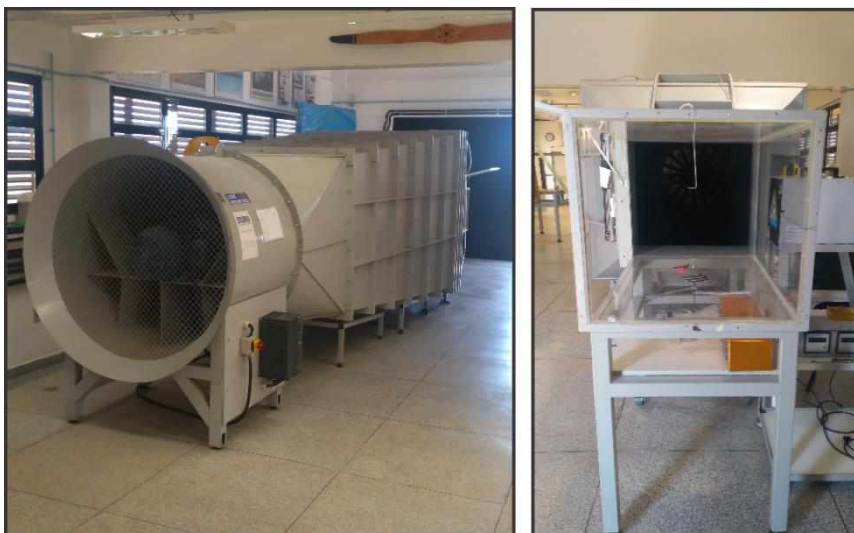
Figura 14 – Túnel de vento TV60
