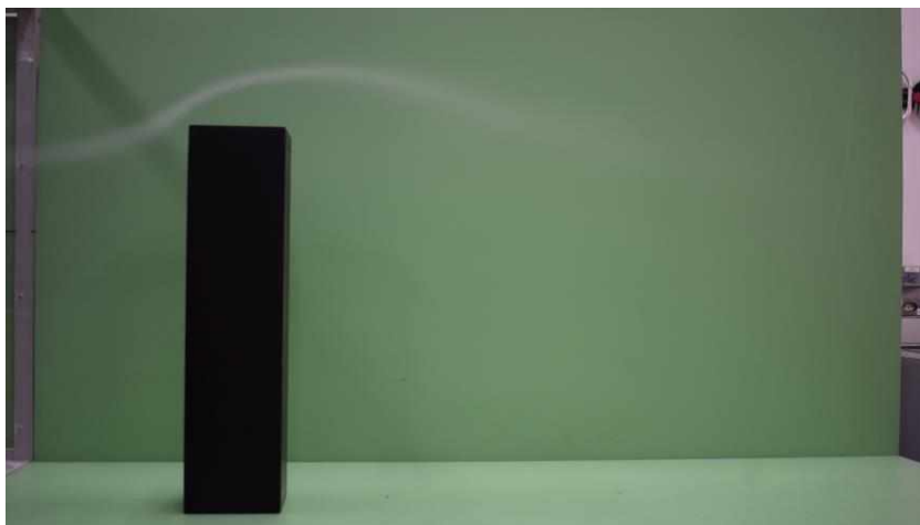
Figura 50 – Escoamento a 16m/s, razão de aspecto 4
