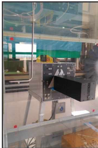
Figura 24 – Situação real experimental para medição de arrasto
