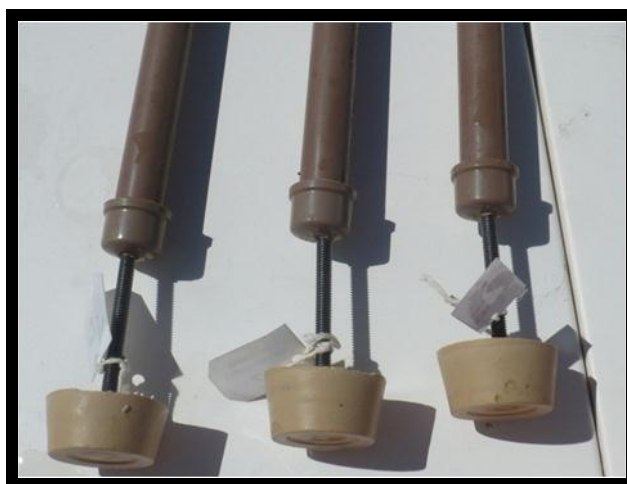
Figura 3 – Estruturas com blocos de gesso utilizadas para avaliação do hidrodinamismo nos três locais de coleta em Ubatuba, litoral norte do estado de São Paulo.
