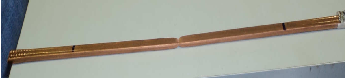
Figura 5.8 - Barra de cobre após o rompimento no ensaio de tração
