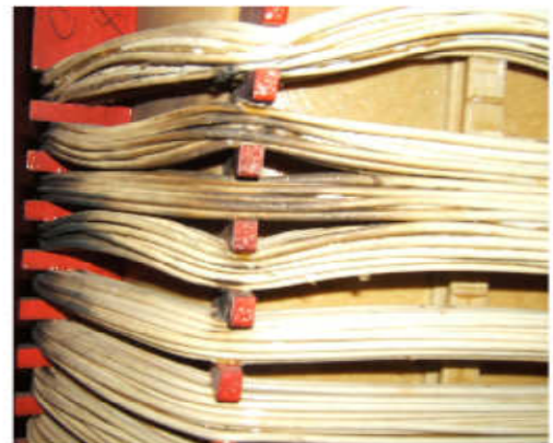
Figura 2.4 - Efeitos típicos de estresse eletromecânico nos enrolamentos causados por forças axiais
