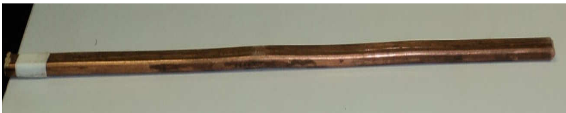
Figura 5.4 - Barra de cobre eletrolítico utilizada no ensaio de tração
