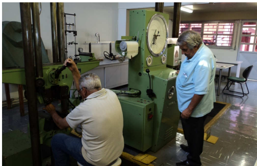
Figura 5.7 - Realização dos ensaios de tração nas barras de cobre
