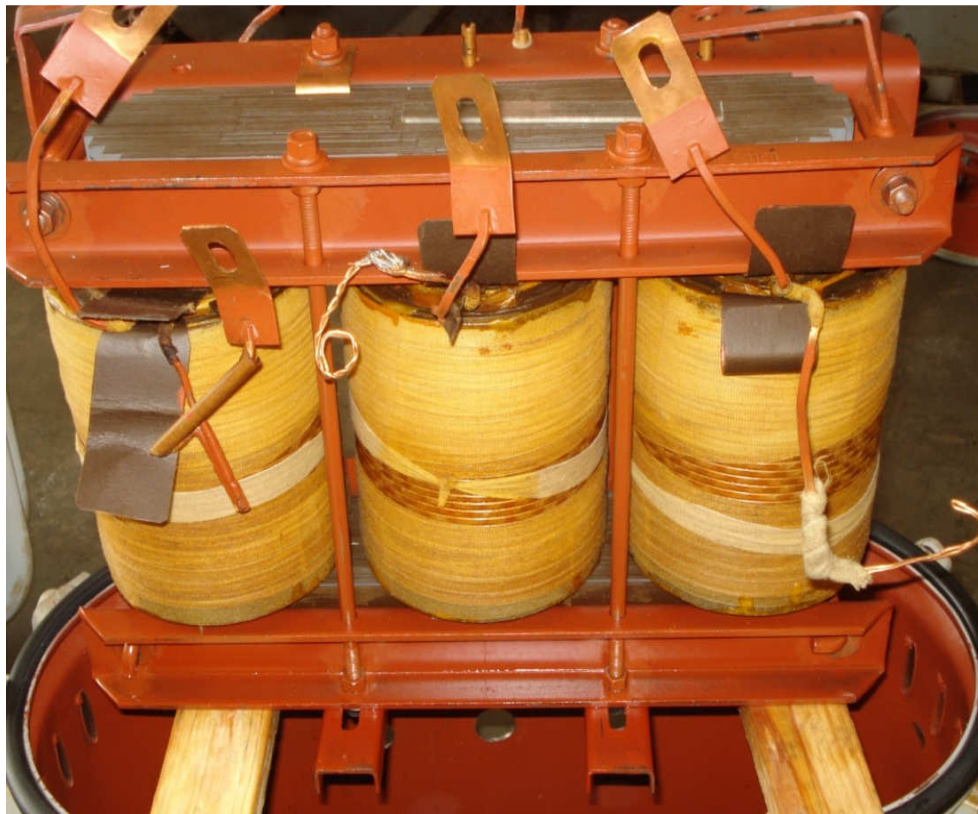
Figura 2.6 - Fotografia do transformador de 15 kVA utilizado
