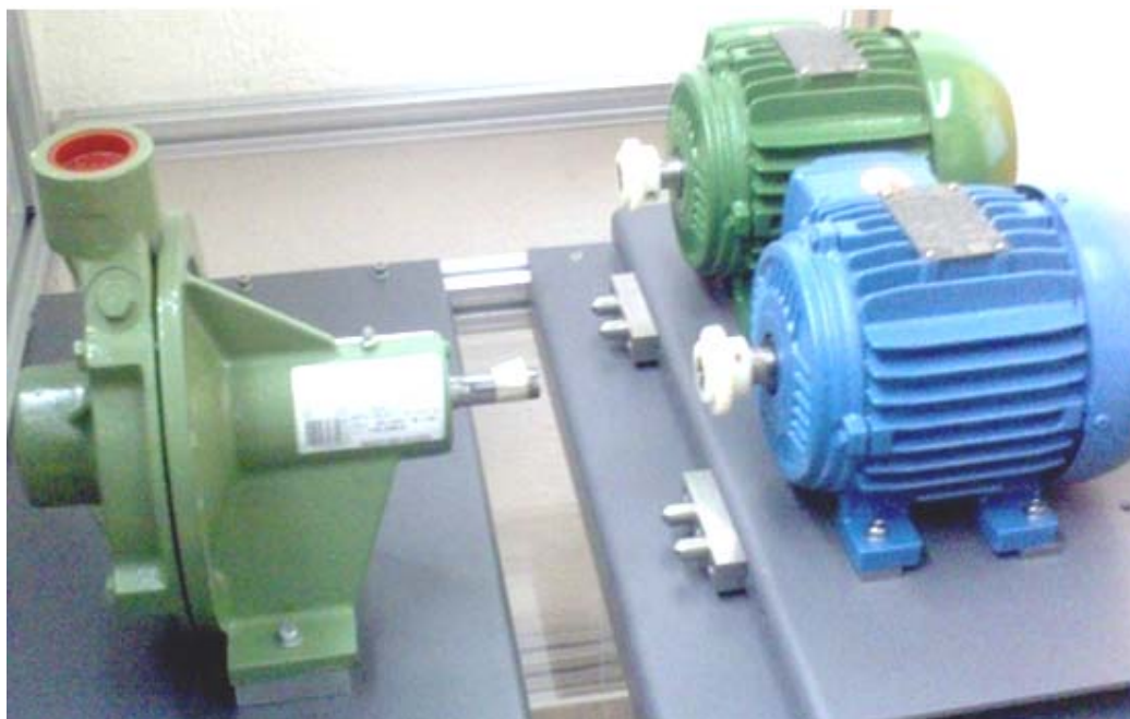
Figura 3.4 – Conjunto motor-bomba fixos na bancada
