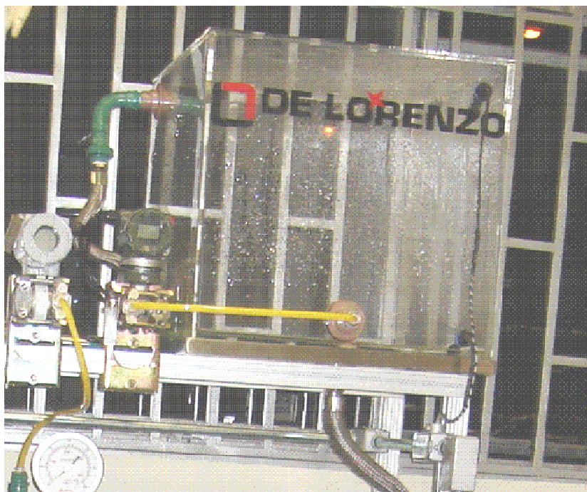
Figura 3.6 – Reservatório superior da bancada de bombeamento
