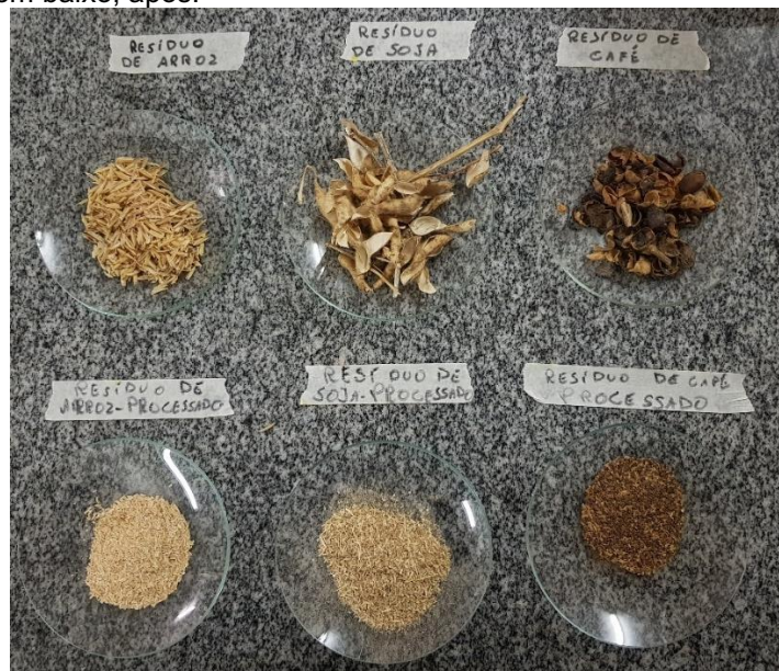
Figura 9 - Resíduos de arroz, soja e café, respectivamente. Na parte de cima, estão os resíduos antes do processamento, em baixo, após.
