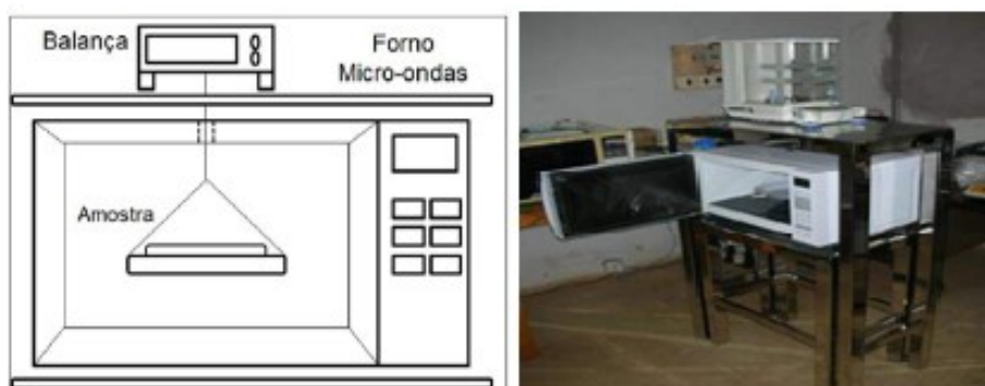
Figura 3.3: Secador Micro-ondas a) Figura Esquemática b) Equipamento
