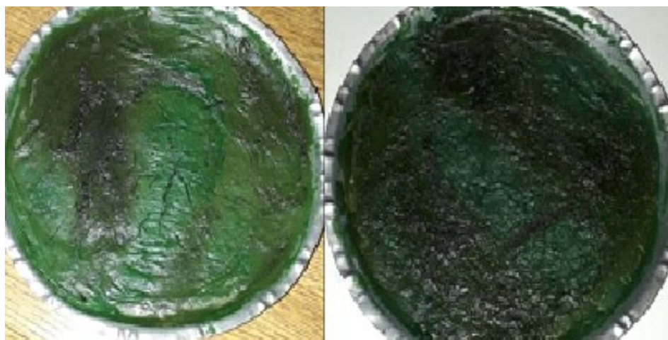
Figura 4.2: Microalga Spirulina platensis após Secagem por Infravermelho a 80°C e 110°C
