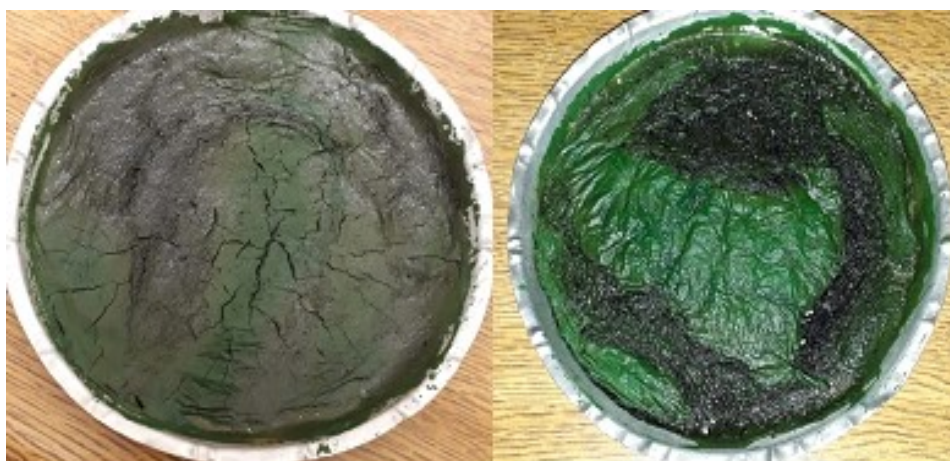
Figura 4.3: Microalga Spirulina platensis após Secagem Intermitente por Infravermelho a 80°C→ 50°C e 110°C→ 50°C
