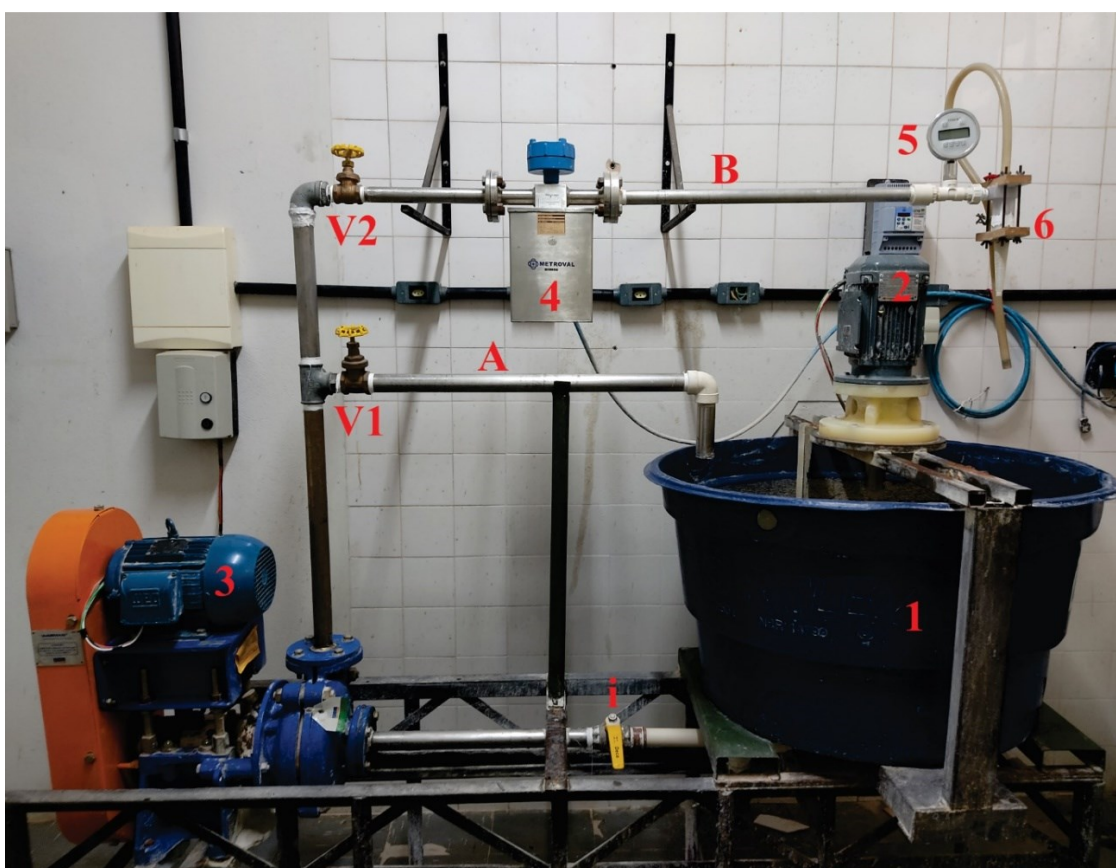
Figura 3.9 – Unidade experimental de hidrociclonação do LASER-UFU.
