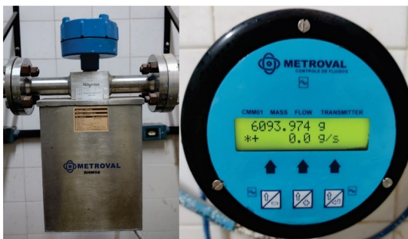
Figura 3.10 – Medidor de vazão mássica instalado na unidade experimental: sensor Coriolis (esquerda) e painel de exibição dos dados (direita).
