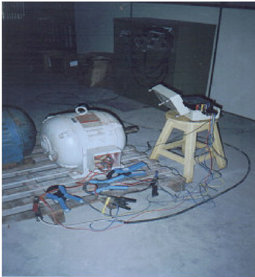
Figura A-1 – Montagem do Motor Trifásico Convencional para o Ensaio a Vazio
