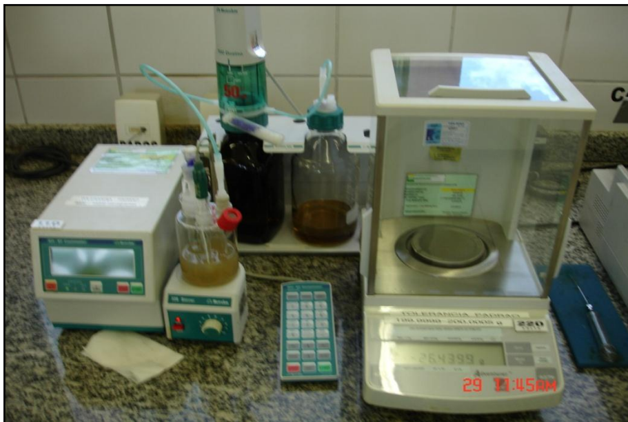
Figura 15: Aparelho de Karl Fischer utilizado para determinação de água nos óleos e biodieseis.
